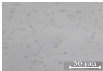
Рис. 3. Поверхня варикапної структури, виготовленої з використанням гетерування дифузійним легуванням
