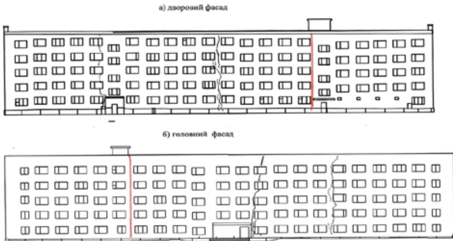
Рис. 1. Фасади гуртожитку №3 з нанесеними зонами деформацій (— температурний шов; — ділянки тріщин)
