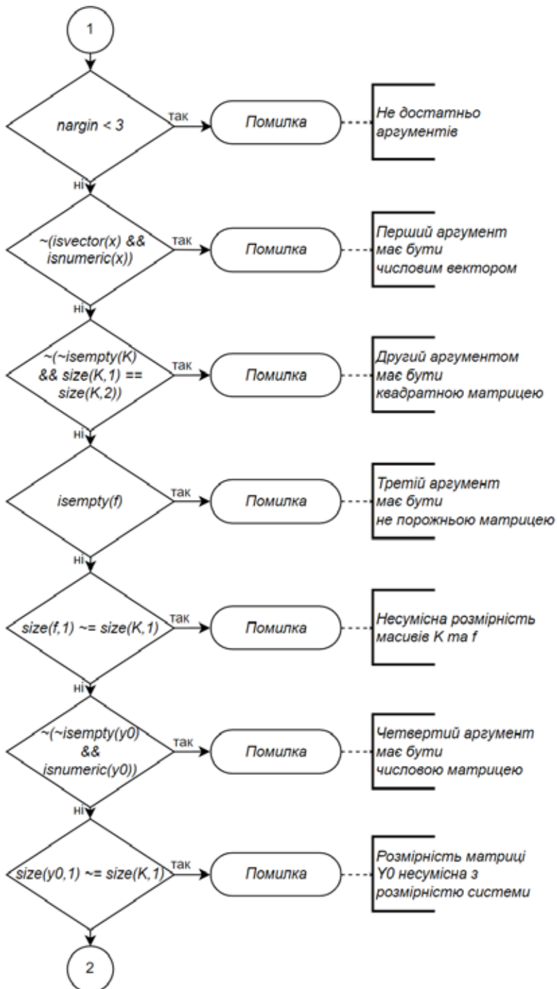
Рис. 2. Алгоритм роботи модуля розв'язання системи лінійних інтегральних рівнянь Вольтера II роду в системі MATLAB (процес перевірки коректності вихідних даних)
