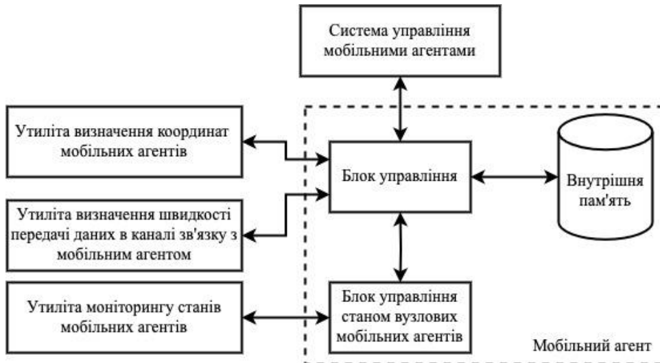
Рис. 2. Структурна схема мобільного агента
