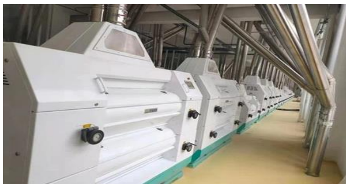
Рис. 3. Технологічне обладнання для виготовлення рисового борошна
