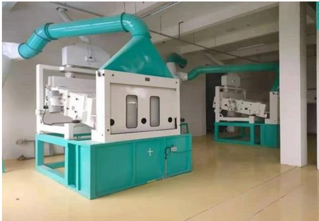
Рис. 2. Технологічне обладнання для одержання гречаного борошна
