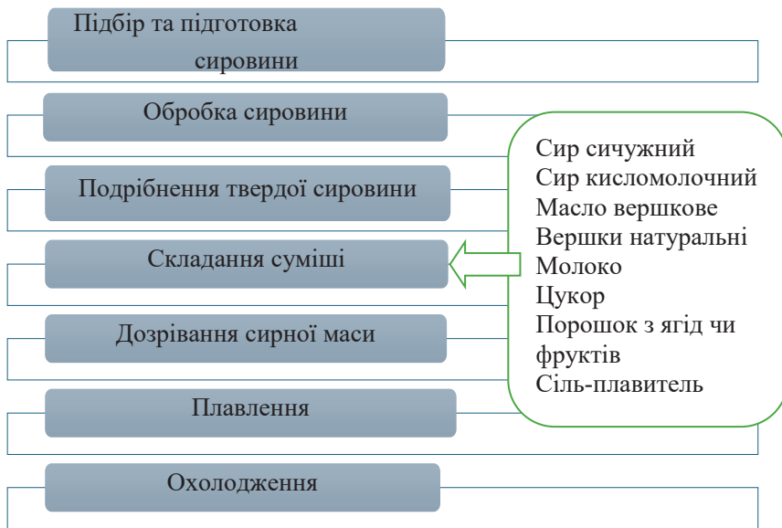
Рис. 2. Технологічна схема виготовлення десертних плавлених сирів підвищеної біологічної цінності
