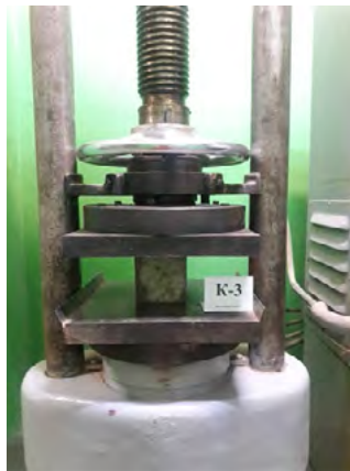
Рис. 2. Загальний вигляд випробування куба бетону
