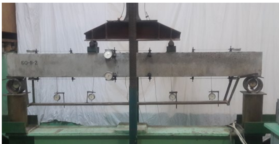
Рис. 6. Загальний вигляд випробування звичайної балки БО-II-2
