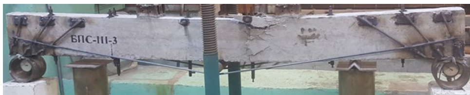
Рис. 5. Характер руйнування залізобетонної балки БПС-III-3
