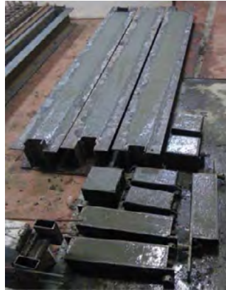
Рис. 1. Формування дослідних балок БО-II-2 і БПС-III-3 та супутніх зразків
