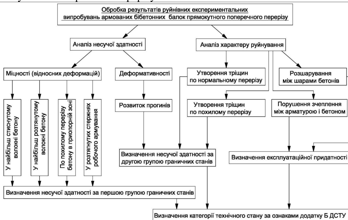
Рисунок 2 – Структурно-логічна схема обробки результатів руйнівних експериментальних випробувань дослідних зразків
