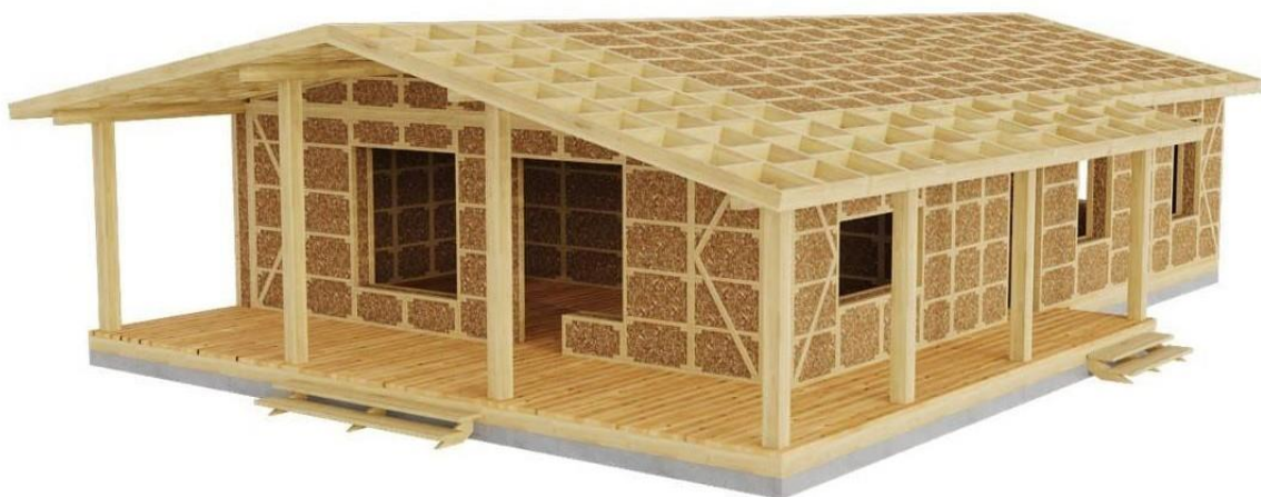
Рис. 5. Зведена будівля з утепленим дахом
