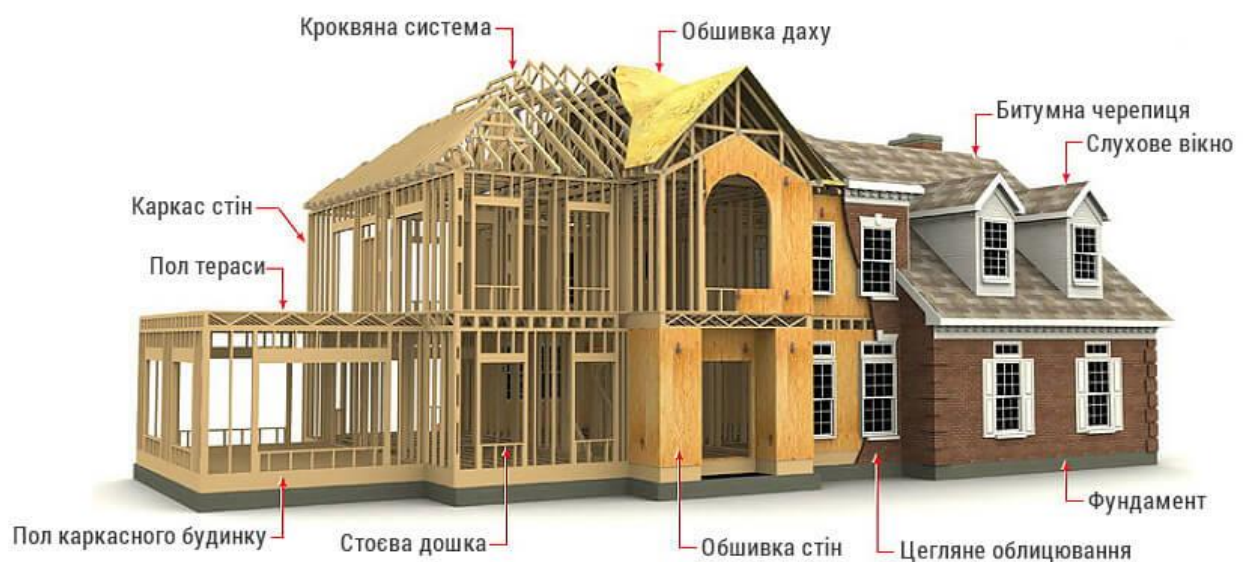
Рисунок 1 – Конструкція дерев'яного каркасного будинку
