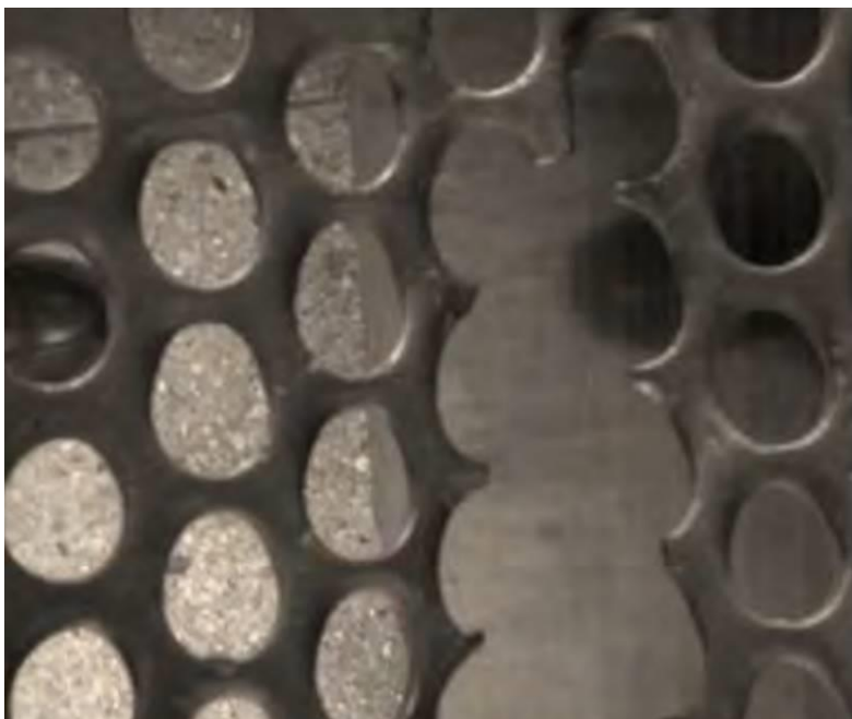
Рис. 3. Характер руйнування сепаруючого решета
