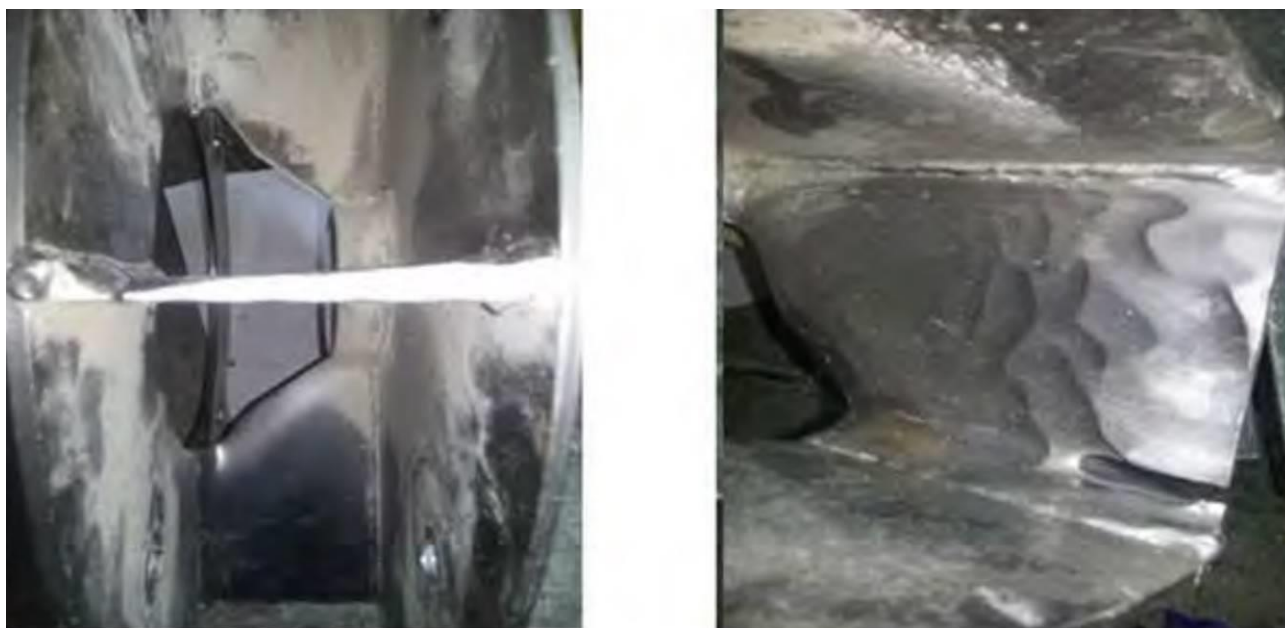
Рис. 4. Характер руйнування поверхні лопатей барабана
