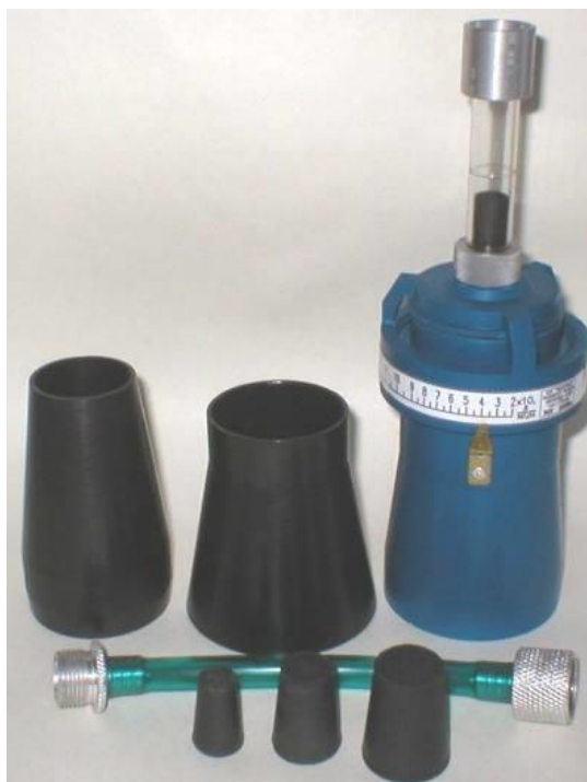
Рис. 3. Витратомір картерних газів КИ-17999М
