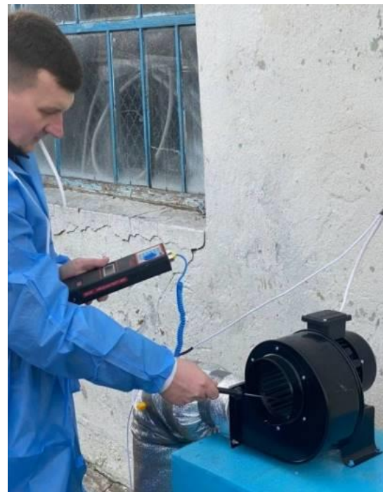
Рис. 3. Процес проведення досліджень вентиляційної системи нагнітання чистого повітря у виробничих умовах
