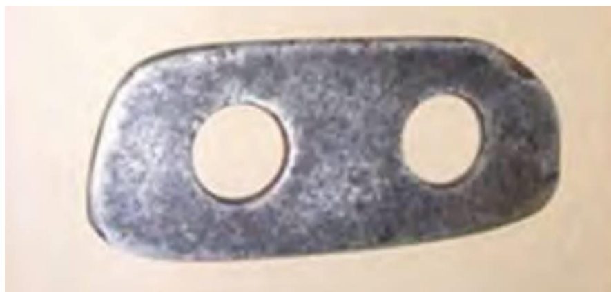
Рис. 2. Зношений молоток дробарки
