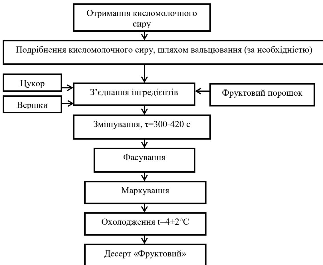
Рис. 1. Принципова технологічна схема приготування сиркового десерту
