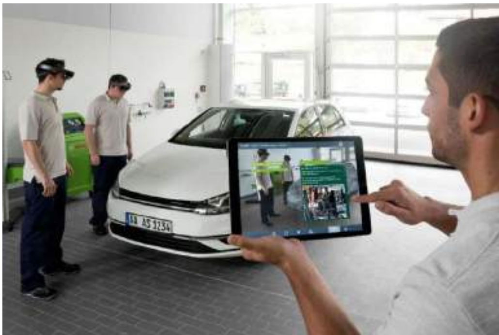
Рис. 4. Застосування AR-окулярів під час проведення ТС автомобіля
