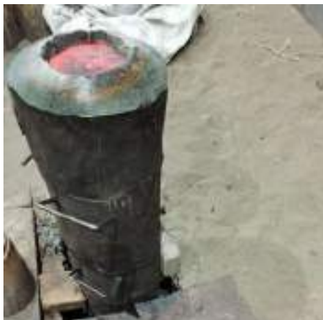
Рис. 2. Відливання електродів відкритої індукційної виплавки
