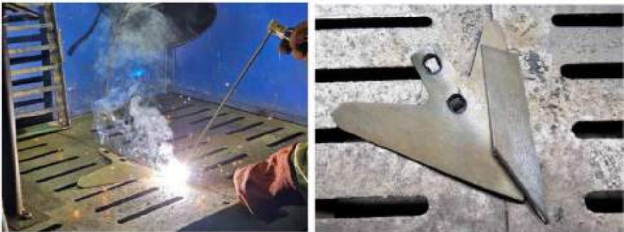
Рис. 6. Приварювання низьколегованих пластин
